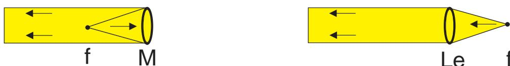
O a la inversa, un haz de luz paralelo dirigido al espejo M, convergerá en el punto focal. Esto ocurre en un telescopio Newton (véase el dibujo de abajo a la izquierda).
