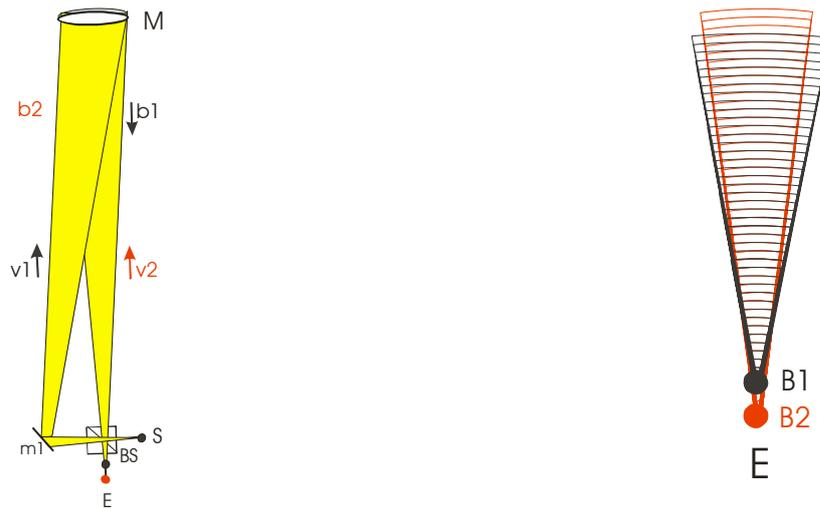
El dibujo de arriba a la izquierda ilustra la trayectoria de la luz en el montaje básico (un montaje cerrado con trayectoria de luz irregular). El dibujo de la derecha muestra un detalle del recorrido de la luz cerca de E. Los haces parciales convergentes b1 y B1 aún no coinciden. Si nos miramos en el espejo, veremos líneas o círculos. Si coinciden, las líneas o círculos son tan anchos que caen fuera de la superficie del espejo.
