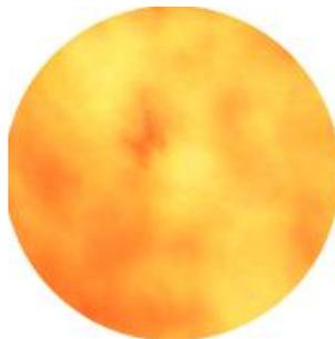
Se si ruota leggermente la vite di regolazione di uno degli specchi piani, il colore della superficie dello specchio cambia, ad esempio, in blu..
