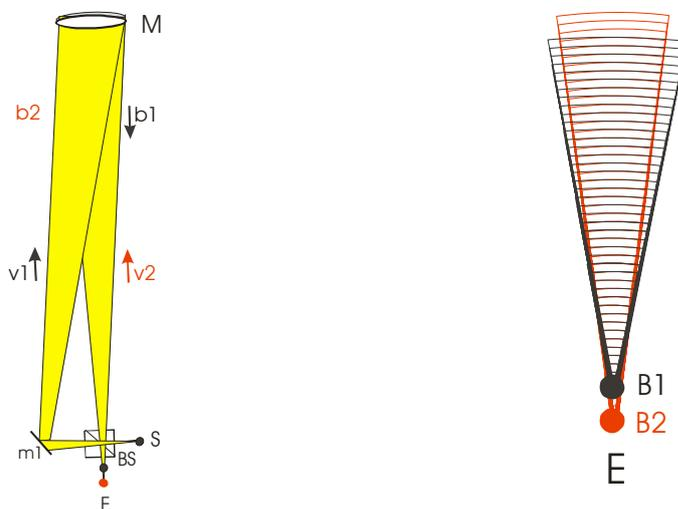
Il disegno in alto a sinistra illustra il percorso della luce nel setup di base (un setup chiuso con percorso della luce non uniforme). Il disegno a destra mostra un dettaglio del percorso della luce vicino a E. I fasci parziali convergenti b1 e B1 non coincidono ancora. Se guardiamo nello specchio, vedremo linee o cerchi. Se coincidono, le linee o i cerchi sono così ampi da uscire dalla superficie dello specchio.
