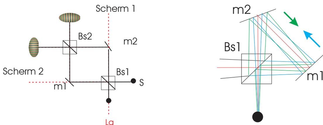
Nella disposizione sottostante, vediamo due percorsi luminosi distinti. Un primo raggio attraversa la disposizione in senso orario, mentre il secondo lo fa in senso antiorario.
