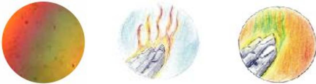
Quando portiamo la mano nel percorso della luce, vediamo una serie di filamenti colorati che salgono da essa. La mano è più calda dell'aria circostante e riscalda gli strati d'aria vicini. Ciò modifica l'indice di rifrazione dell'aria in quel punto, dando origine a questi ciuffi. Lo si può vedere anche nell'immagine in basso a sinistra.
