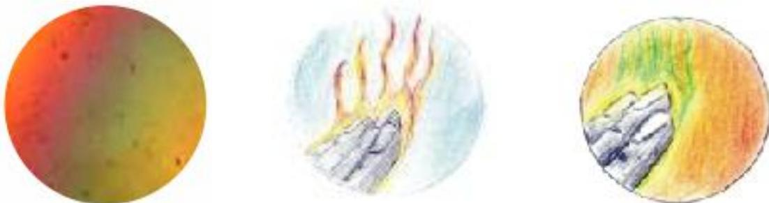
Wenn wir die Hand in den Lichtweg bringen, sehen wir eine Reihe von farbigen Fäden, die von ihr ausgehen. Die Hand ist wärmer als die umgebende Luft und erwärmt diese nahe gelegenen Luftschichten. Dadurch ändert sich der Brechungsindex der Luft an dieser Stelle, was zu diesen Strahlen führt. Wir können dies auch im Bild unten links sehen.
